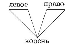
Левое и правое поддеревья вершины  $x$  могут быть пустыми, а поддерево с корнем в  $x$  всегда непусто (содержит по крайней мере  $x$ ). Высотой поддерева будем считать максимальную длину цепи  $y_1 \dots y_n$  его вершин, в которой  $y_{i+1}$  — сын  $y_i$  для всех  $i$ . (Высота дерева из одного корня равна единице, высота пустого дерева — нулю.)
