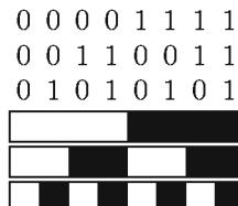
мы измерим угол с точностью до 45° и т. д. Эта идея имеет, однако, недостаток: в момент пересечения границ сразу несколько фотоэлементов меняют сигнал, и если эти изменения произойдут не совсем одновременно, на какое-то время показания фотоэлементов будут бессмыслицами. Коды Грея позволяют избежать этой опасности. Сделаем так, чтобы на каждом шаге менялось показание лишь одного фотоэлемента (в том числе и на последнем, после целого оборота).
